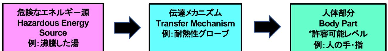
危険エネルギー源が大きさ、継続時間の条件において存在する場合、そのエネルギーを適切に減衰させるものをその危険エネルギー源と人体の間に入れて対策することでたとえ接触しても、人体が接するエネルギーは安全なレベルとなります。この減衰器はエネルギーを遮断し、危険エネルギー源を取り除くことで、傷害の発生を完全になくすることができます。
