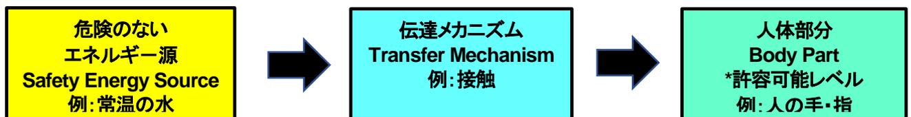
エネルギーの大きさと継続時間の限界値を、人体に傷害を生じないで耐えられる最高のレベルに設定します。エネルギーの大きさとそれにかかる時間が人体の耐えられる度合を超えない限り、被害はないこととなります。例えば、室温と同じ水は、危険なエネルギー源ではなく、指がその水に触れても人体に伝達されるエネルギーは許容可能なレベルにあります。
