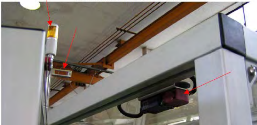
Door interlock switch and actuator
